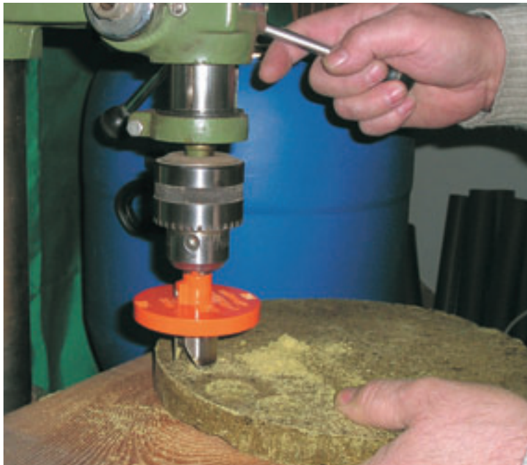
Mit einem variablen Holzlochsneider und Kernbohrer werden die runden Stücke aus der Platte geschnitten
